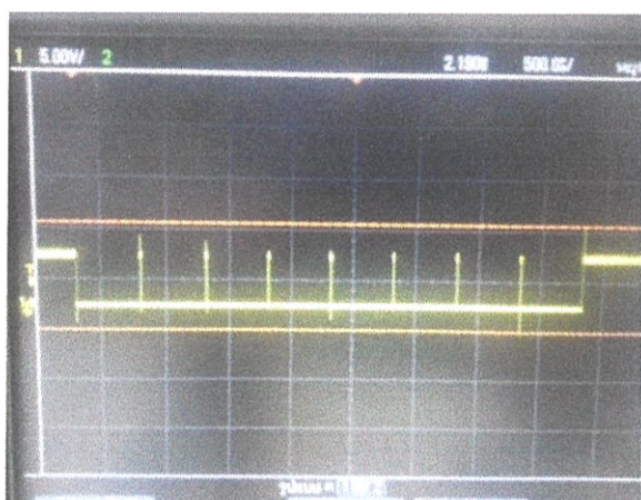
รูปที่ 4.17 พัลส์ขา LOAD ของ MAX7219
