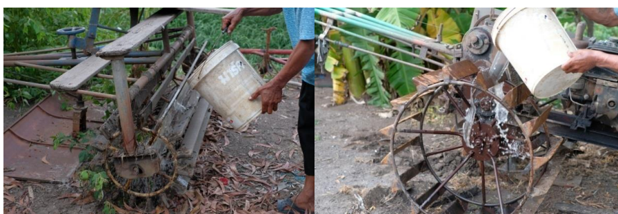
ภาพที่ 4.13 การทำความสะอาดลูกทูปดินและรถไถนา
