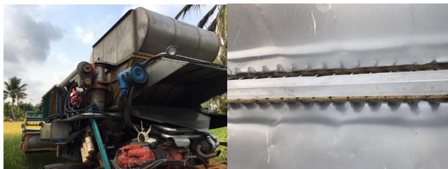
ภาพที่ 4.8 ลักษณะของตัวถังเก็บข้าวเปลือกที่มีข้าวเปลือกตกค้าง
