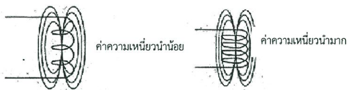
รูปที่ 2.24 ความสัมพันธ์ระหว่างความยาวของขดลวดกับค่าความเหนี่ยวนำ
