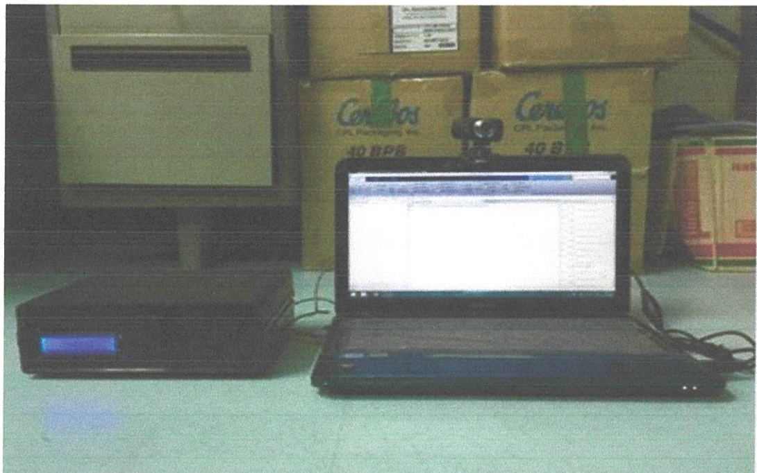
รูปที่ 3.12 ระบบจำลองการตรวจจับและแจ้งเตือนคนง่วงขณะขับรถที่พร้อมใช้งาน
