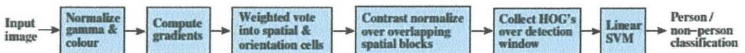
รูป 2.5 ลำดับการทำงานของ Histogram of Oriented for Human Detection
