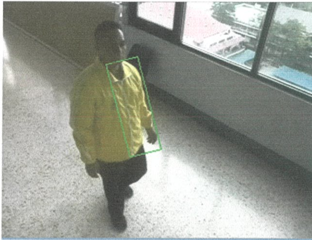
รูปที่ 4.2 ผลตัวอย่างภาพที่ได้จากการทำงานในโหมดตรวจจับวัตถุสีเหลือง
