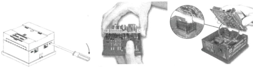
รูปที่ 6.6 แสดงการตั้งค่า RS485 ทางด้านหลังวงจรมีแอลซี
