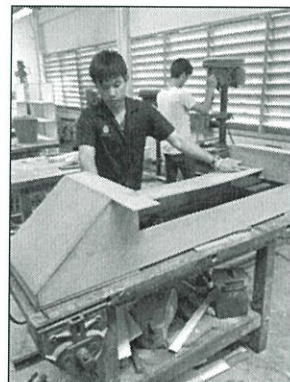
ภาพที่ จ.1.2 แสดงการสร้างและประกอบชิ้นส่วนต่างๆ ของอุปกรณ์ช่องอากาศใบพัดเข้าด้วยกัน
