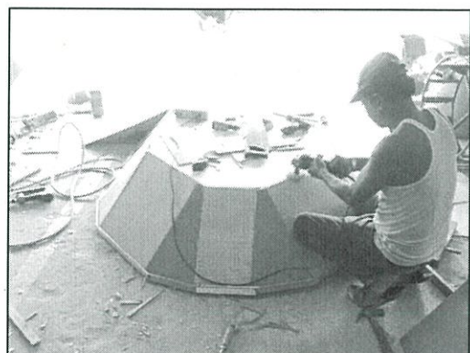
ภาพที่ จ.2.3 แสดงการประกอบแผ่นไม้อัดตามโครงสร้างของเรือสะเทินน้ำสะเทินบก
