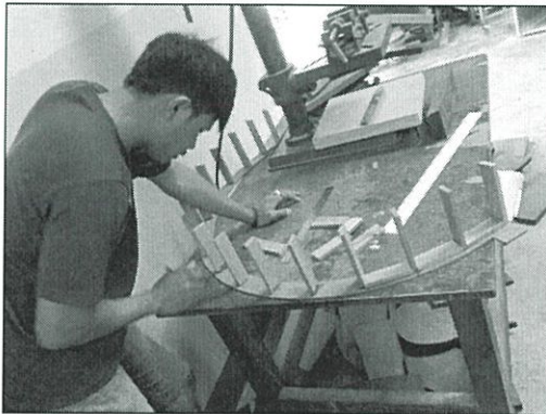
ภาพที่ จ.1.2 แสดงการสร้างและประกอบชิ้นส่วนต่างๆ ของอุปกรณ์ช่องอากาศใบพัดเข้าด้วยกัน
