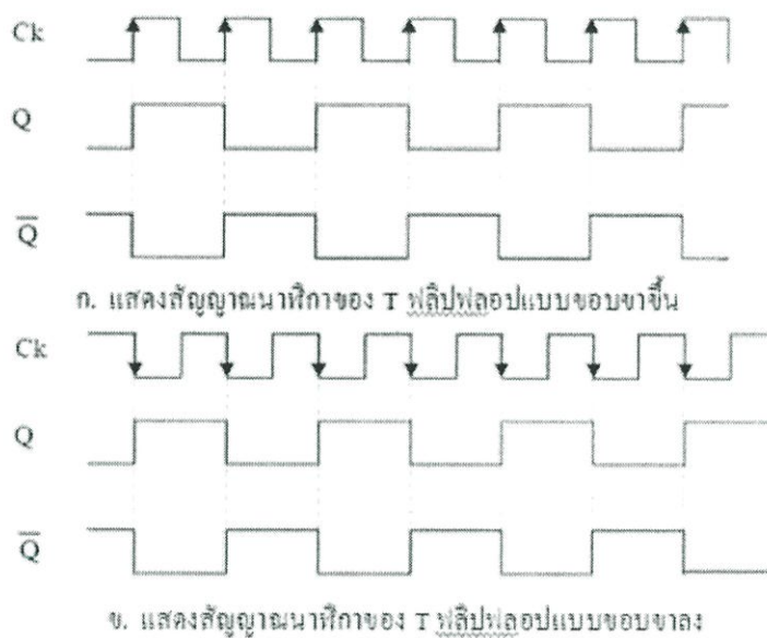
ภาพที่ 2.24 ไดอะแกรมเวลาของทีฟลิปฟลอป
