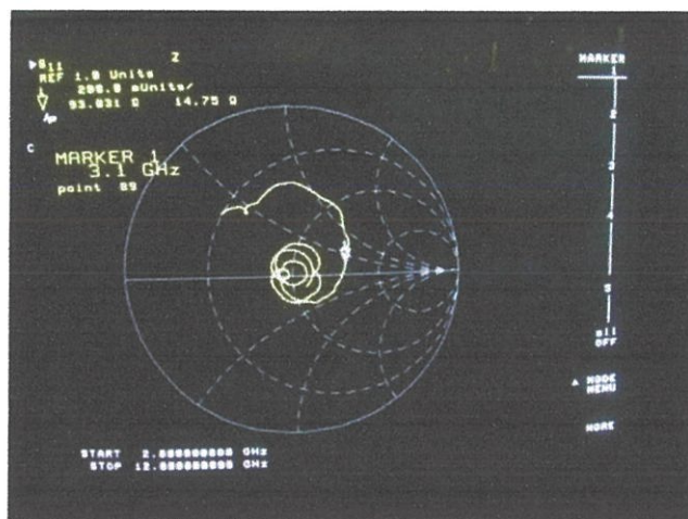
รูปที่ 4.3 ผลการทดสอบค่าอิมพีแดนซ์ของสายอากาศแบบไมโครสตริป
