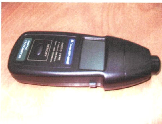
รูปที่ 3.10 มิเตอร์วัดรอบ Photo Tachometer MDT-2244B
