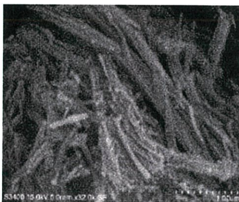
รูปที่ 4.7 โครงสร้างโซเดียมท่อนาโนไททาเนต ( \text{Na}_2\text{Ti}_3\text{O}_7 )
