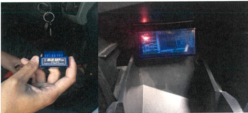
รูปที่ 4.1 รูปแสดงการเชื่อมต่อ OBDII กับ รถยนต์
