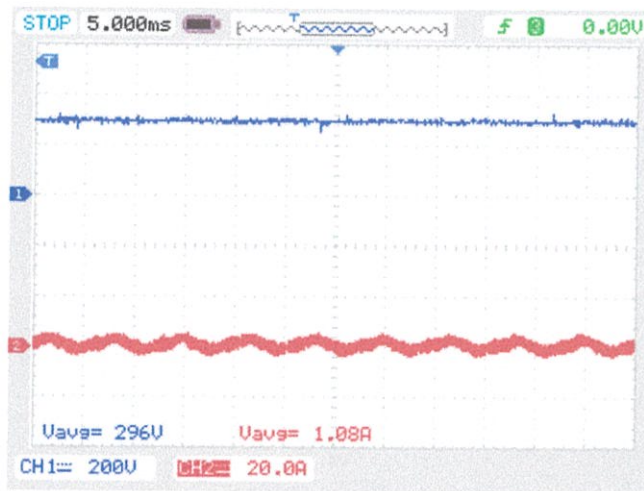
รูปที่ 5.17 รูปคลื่นแรงดันและกระแสขาเข้าเมื่อต่อภาระที่ 260 W
