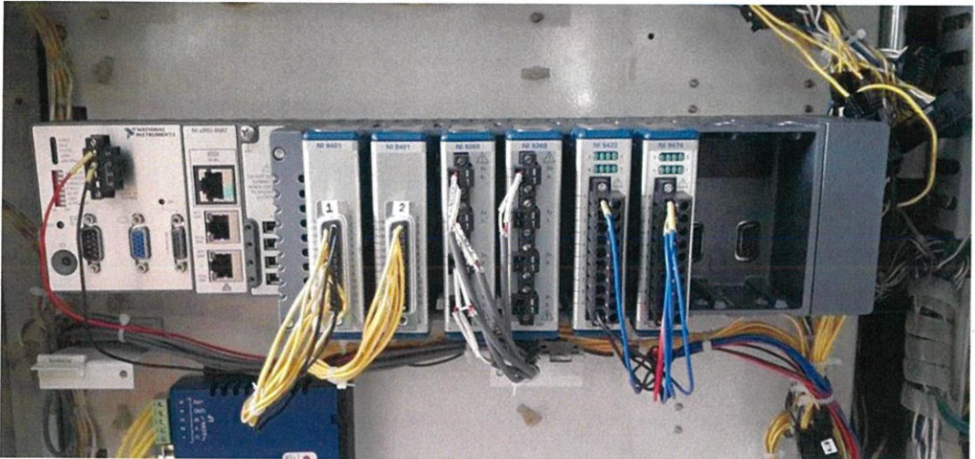
รูปที่ 3.28 ภาพการเชื่อมต่อ cRIO กับโมดูล NI
