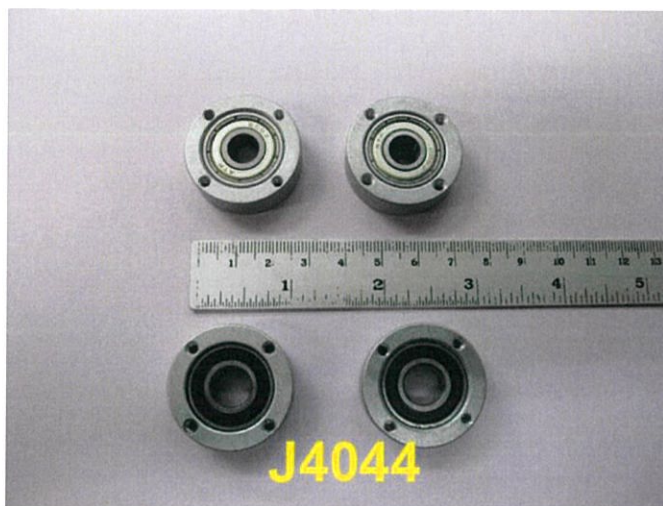
รูปที่ 3.18 แสดงรูปตลับลูกปืนอะลูมิเนียม
