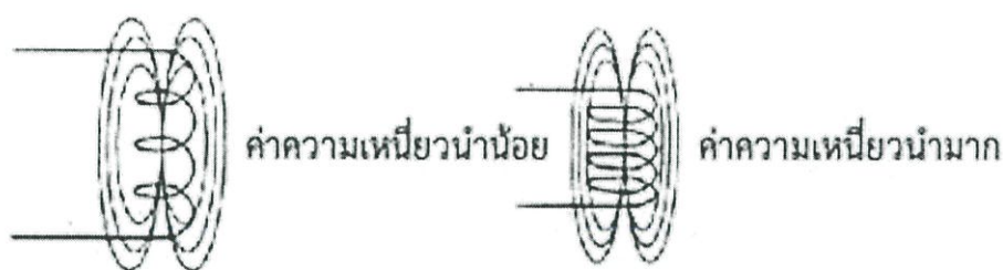
รูปที่ 2.6 ความสัมพันธ์ระหว่างความยาวของขดลวดกับค่าความเหนี่ยวนำ (อ้างอิงโดย http://eakza.igetweb.com/index.php?lite=article&qid=585909 )
