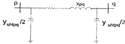
รูปที่ 2.9 วงจรสมมูลพายที่ใช้แทนสายส่ง
