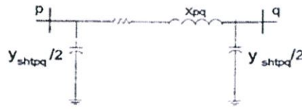
รูปที่ 2.11 วงจรสมมูลพายที่ใช้แทนสายส่ง
