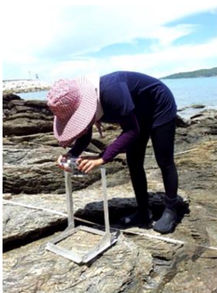
ภาพที่ 3.4 แสดงการติดตั้งกล้องถ่ายภาพดิจิทัลเพื่อทำการถ่ายภาพเก็บข้อมูล
