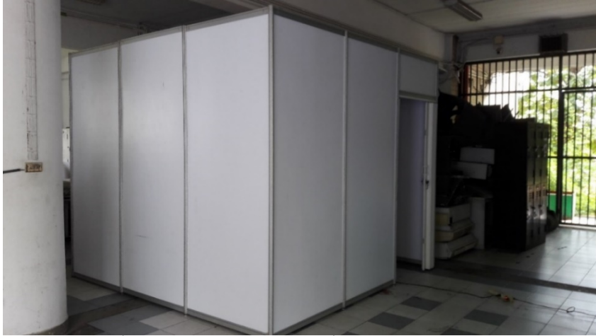
รูปที่ 1 ห้องทดลองจากภายนอก (ขนาดกว้าง 3 เมตร x ยาว 3 เมตร x สูง 3 เมตร)
