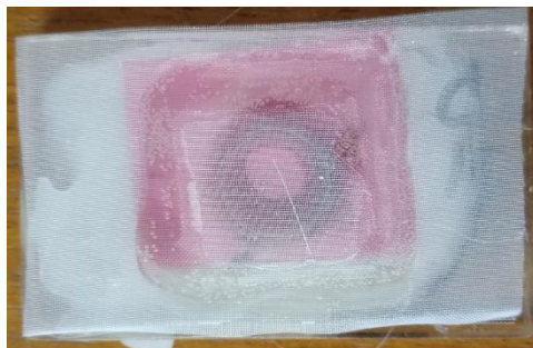
รูปที่ 3.4 กรงทดสอบไรฝุ่นที่ปิดด้วยกระดาษกรองและผ้าสกรีน
