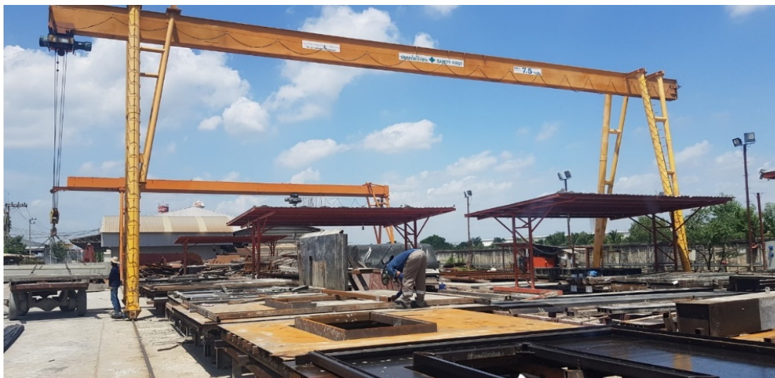
ภาพที่ 2.4 เครนแบบมีขาที่ใช้ในโรงงานผลิตชิ้นส่วนคอนกรีตสำเร็จรูป ขนาด 7.5 ตัน
