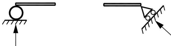
ภาพที่ 2.10 แสดงสัญลักษณ์ของฐานรองรับแบบยึดหมุนเคลื่อนที่ได้ (Roller Supports)
