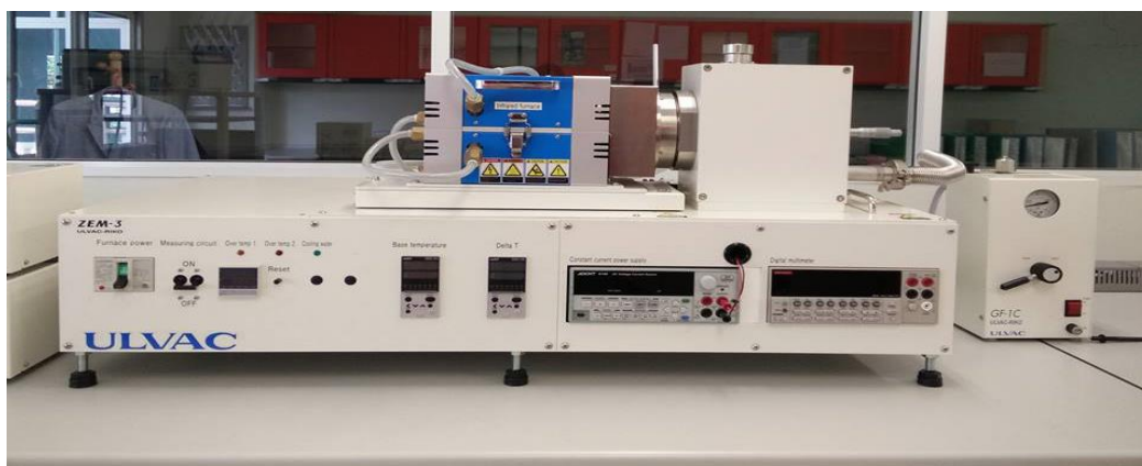
รูปที่ 2.22 แสดงเครื่องวัดค่าสภาพต้านทานไฟฟ้าและสัมประสิทธิ์ซีเบค หรือ ZEM-3
