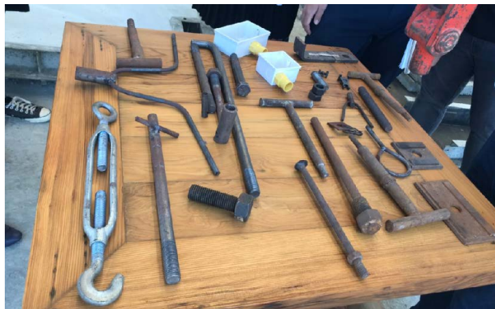
ภาพที่ 2.5 อุปกรณ์ประกอบสำหรับฝังในผนังคอนกรีตสำเร็จรูป
