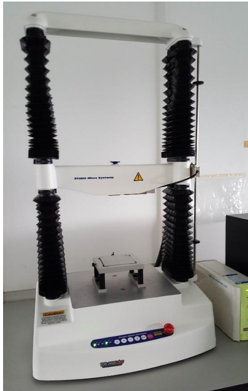
รูปที่ ข.3 เครื่องวัดความแน่นเนื้อ texture ยี่ห้อ Texture Technologies รุ่น Ta-hd plus
