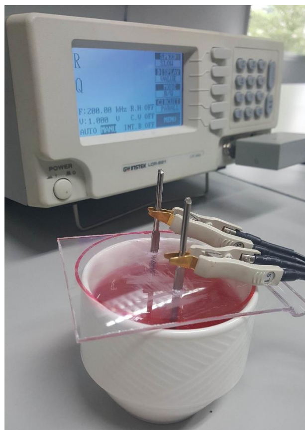
รูปที่ ข.6 การวัดค่าทางไฟฟ้าของเยลลี่โดยแทงเหล็กต่อเข้ากับเครื่อง LCR800
