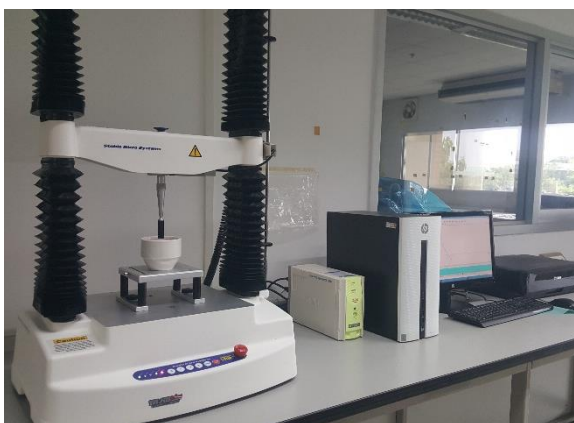
รูปที่ 3.1 แสดงภาพอุปกรณ์การวิเคราะห์ด้วยเครื่อง texture analysis
