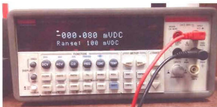
รูปที่ 4.18 การเสียบสายวัดความต่างศักย์เข้ากับ DMM
