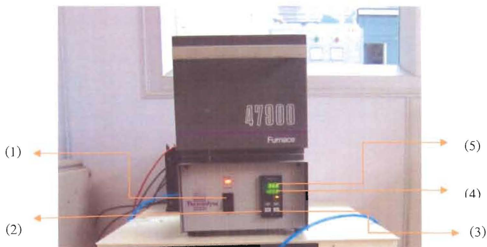
รูปที่ 3.17 เตาเผาใยห่อ Thermolyne มีขนาดกว้าง 13 ซม. ยาว 17 ซม. และสูง 10 ซม. มีอุณหภูมิสูงสุดที่ 1200°C
