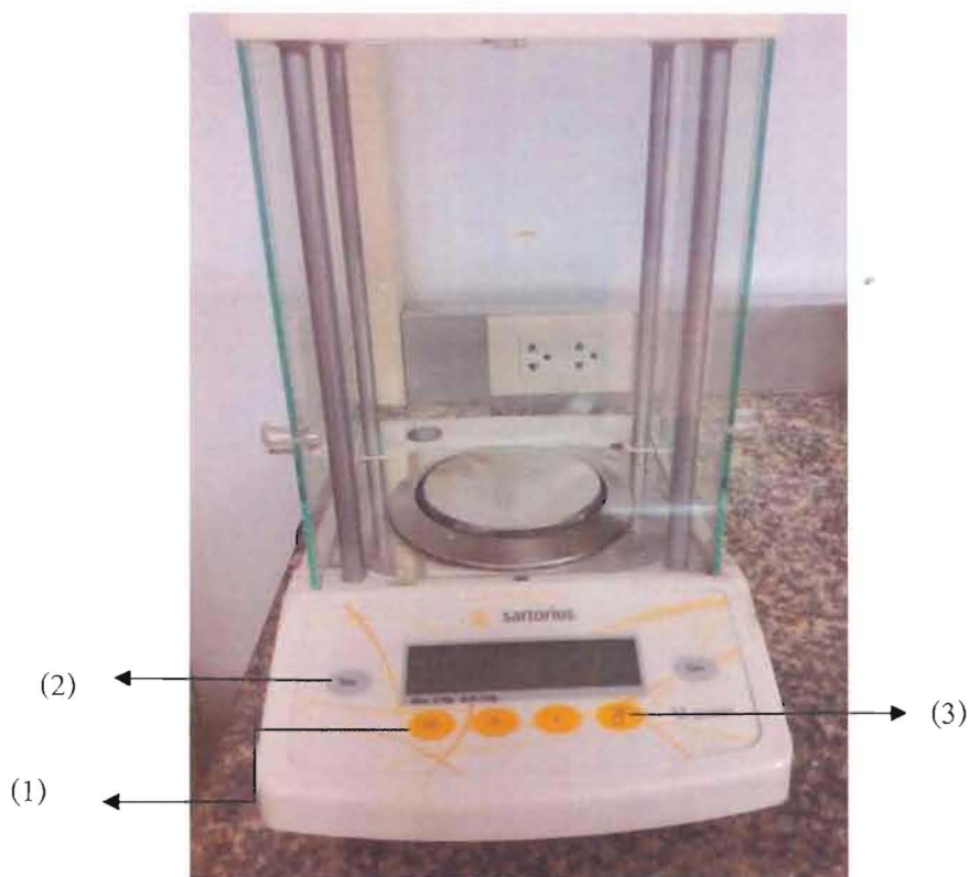
รูปที่ 3.20 เครื่องชั่งทศนิยม 4 ตำแหน่ง ยี่ห้อ Sartorius รุ่น AZ Series
