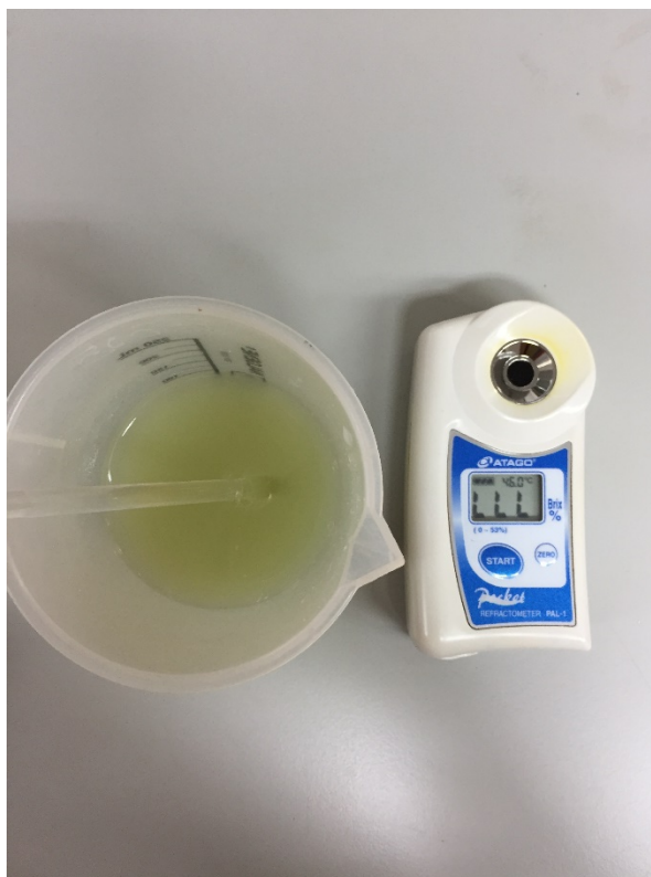
ภาพที่ ค5 การวัดปริมาณของแข็งที่ละลายได้(total soluble solid, TSS) โดยใช้เครื่อง digital refractometer
