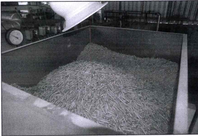
ถังพักเชื้อเพลิงชีวมวลอัดเม็ดก่อนป้อนเข้าห้องเผาไหม้
