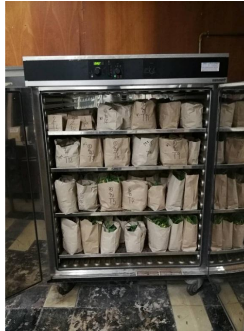
ภาพผนวกที่ 5 การสุ่มหญ้า 1 กิโลกรัม และนำไปเข้าตู้อบ ที่อุณหภูมิ 80 องศาเซลเซียส
