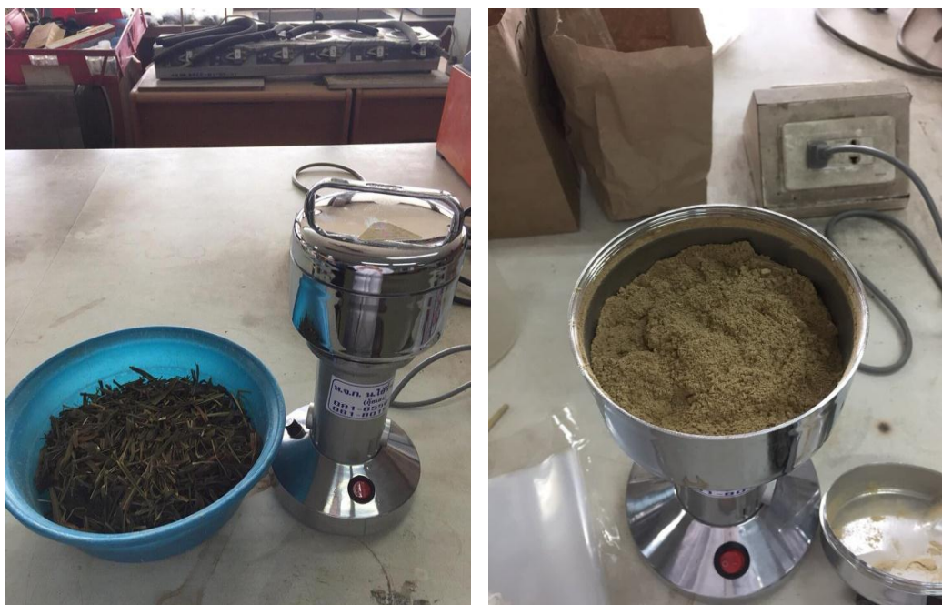
ภาพผนวกที่ 7 การนำต้นและใบมาบดให้ละเอียด เพื่อนำไปวิเคราะห์คุณภาพของหญ้าอาหารสัตว์
