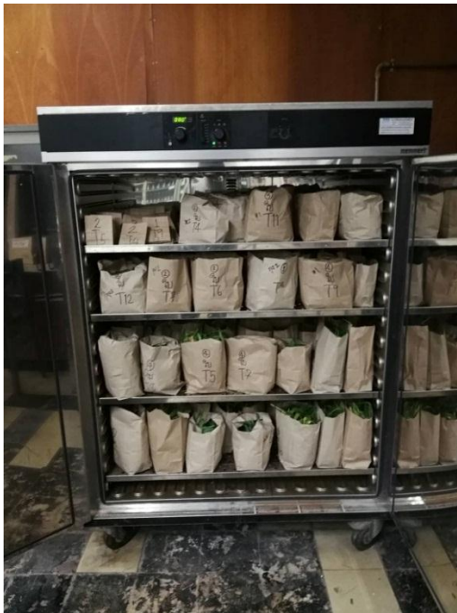
ภาพผนวกที่ 5 การสุ่มหญ้า 1 กิโลกรัม และนำไปเข้าตู้อบ ที่อุณหภูมิ 80 องศาเซลเซียส
