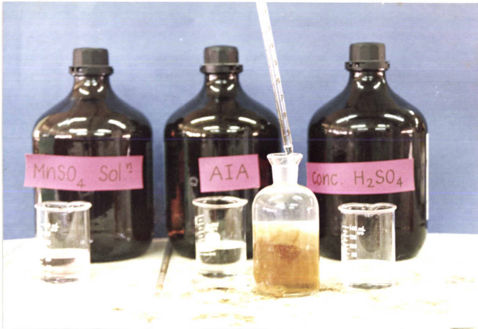
รูปที่ 34 เทคนิคในการใส่กรดซัลฟิวริกเข้มข้น
