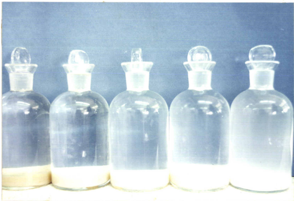
รูปที่ 33 ลักษณะน้ำตัวอย่างที่มีตะกอนสีขาวเมื่อใส่แมงกานีสและเอไอเอแล้ว
