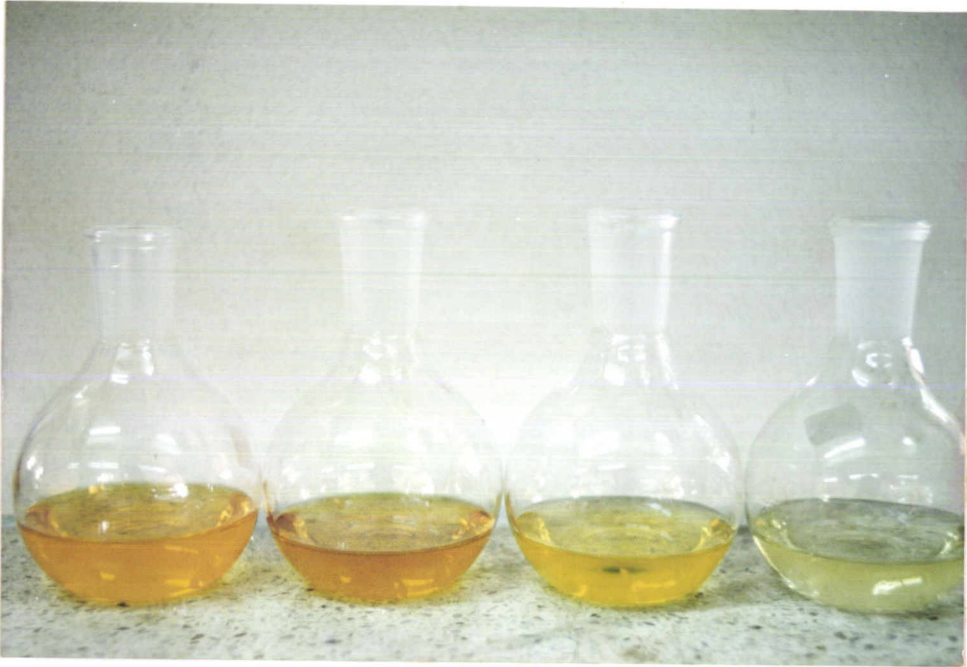
รูปที่ 16 ตัวอย่างน้ำเสียที่ใส่สารเคมีเตรียมวิเคราะห์ ซีโอดี
