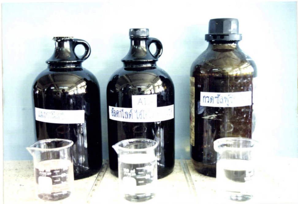
รูปที่ 29 สารเคมีที่ใช้ในการวิเคราะห์การหาปริมาณออกซิเจนที่ละลายในน้ำ
