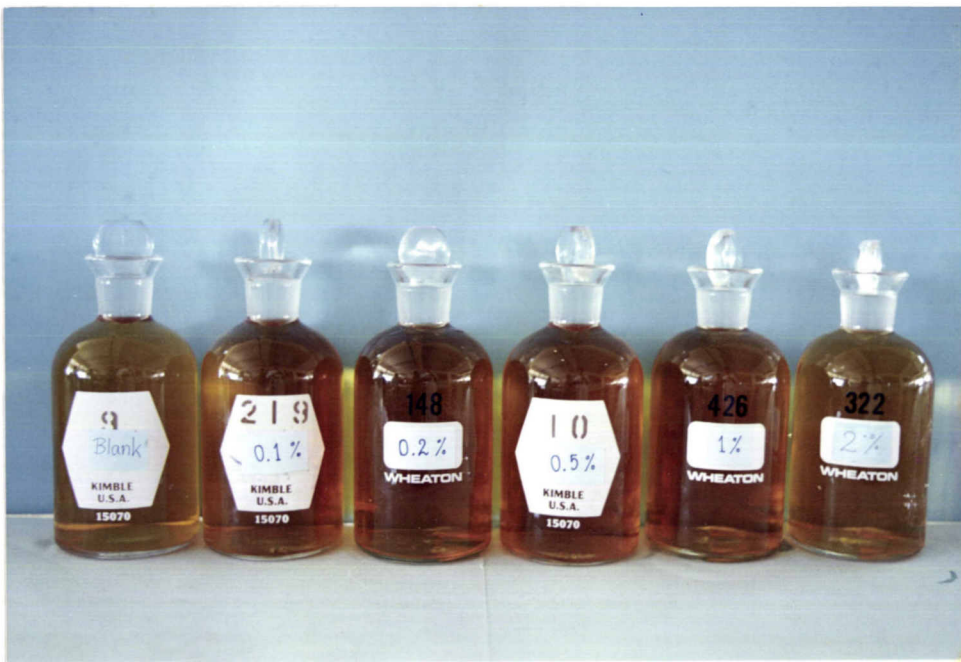
รูปที่ 35 น้ำตัวอย่างที่มีการใส่กรดซัลฟิวริกเข้มข้น
