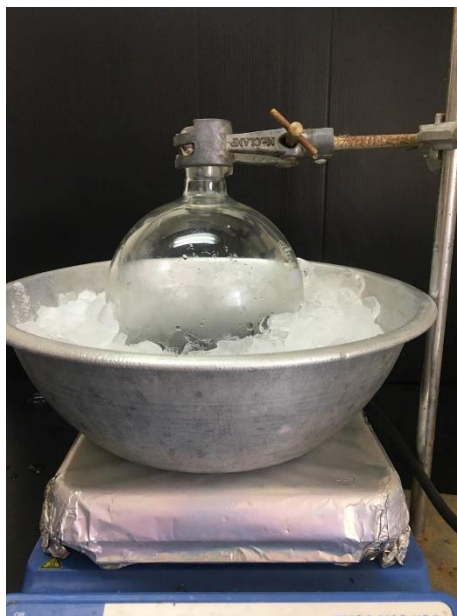
รูปที่ 3.2 การเตรียมกราไฟต์ออกไซด์
