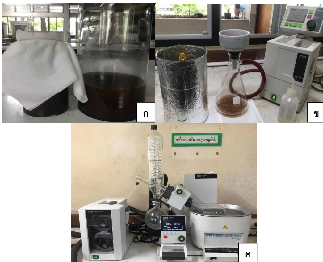
ภาพที่ 3.2 ก: กรองสารด้วยผ้าขาวบาง ข: กรองสารด้วยกระดาษกรอง (Whatman® เบอร์ 1) ค: เครื่องลดปริมาตรอุณหภูมิ (rotary evaporator) รุ่น R 300 (บริษัท BUCHI)
