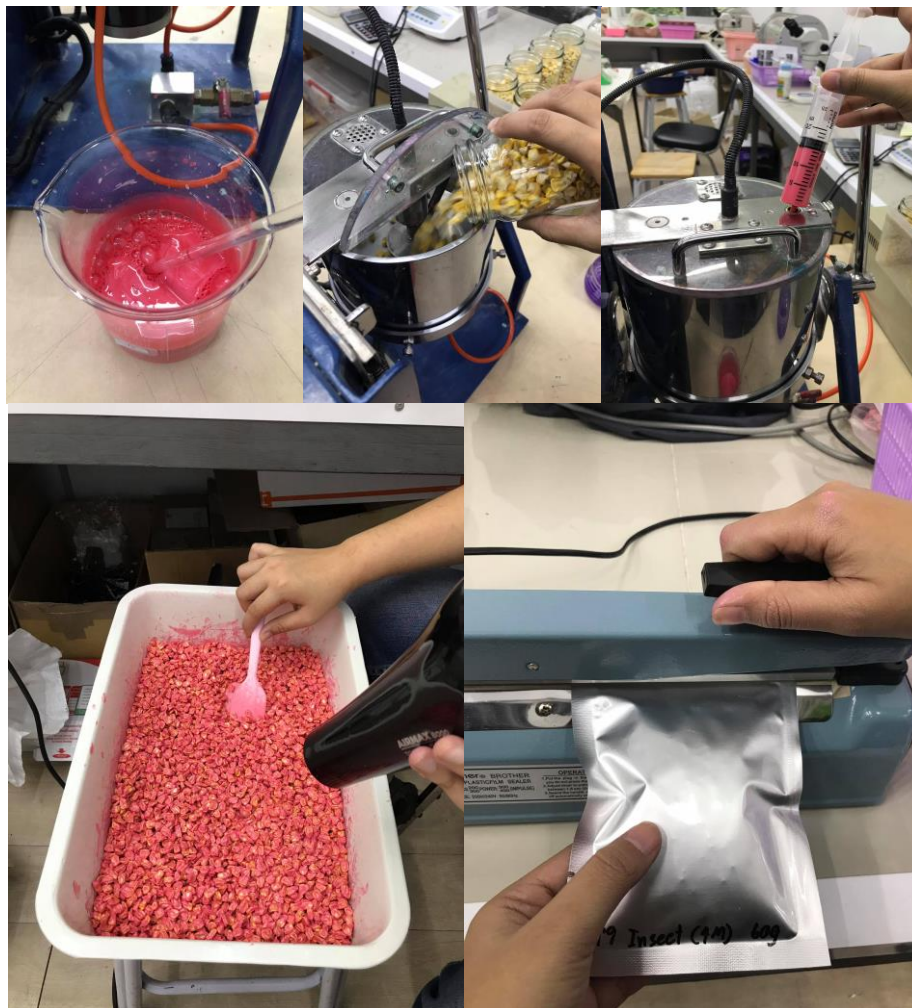
ภาพที่ 3.9 การเคลือบเมล็ดโดยใช้เครื่องเคลือบระบบจานหมุน และการเก็บเมล็ด
