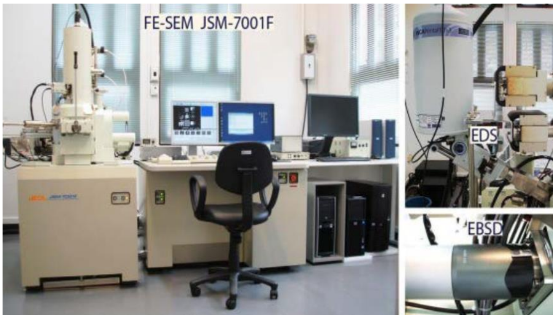
รูปที่ 2.21 กล้องจุลทรรศน์อิเล็กตรอนแบบส่องกราดความละเอียดสูง รุ่น JSM-7001F [29]
