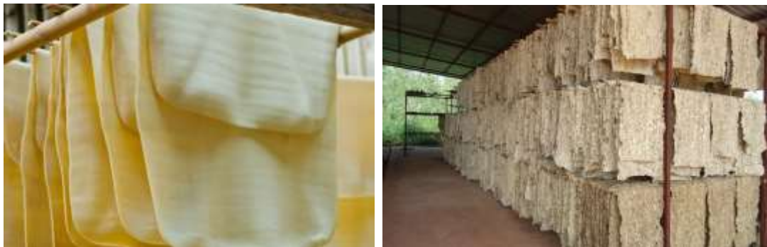
รูปที่ 2.5 แผ่นยางรมควัน (ซ้าย) และยางเครฟ (ขวา) [17,18]
