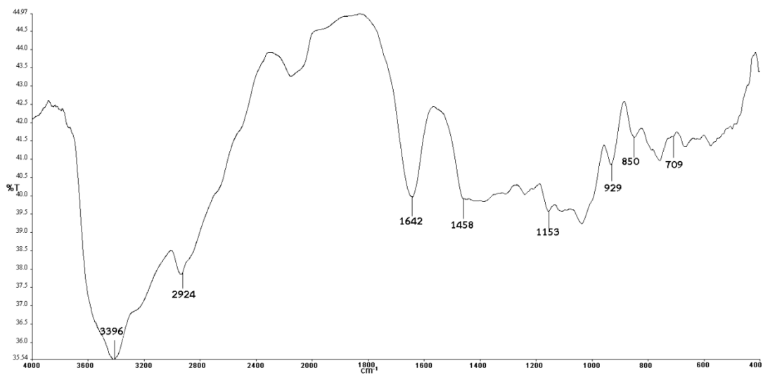
รูปที่ ก.21 อินฟราเรดสเปกตรัมของฟิล์มจากแป้งครอสลิงค์สูตร 3% CSF
