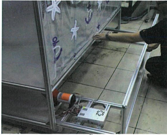
รูปที่ ข.1 แสดงตำแหน่งของปั้มน้ำที่อยู่ใต้บริเวณรางเลื่อน
