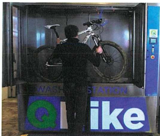
รูปที่ 1.3 แสดงการนำจักรยานเข้าเครื่องโดยผู้ใช้งาน
