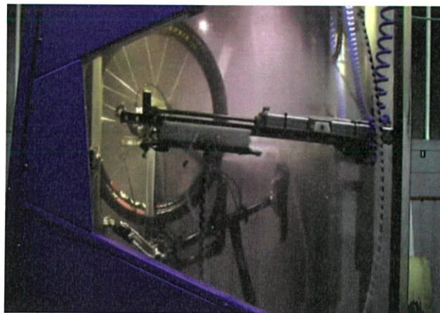
รูปที่ 1.2 แสดงกลไกการทำงานของหัวฉีด ของเครื่องทำความสะอาดจักรยาน GWD
