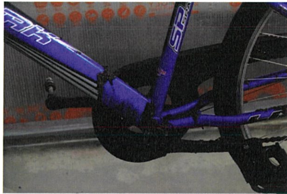
รูปที่ 5.8 ผลการล้างโคลนด้วยหัวฉีดแบบปลาย 45 องศา
