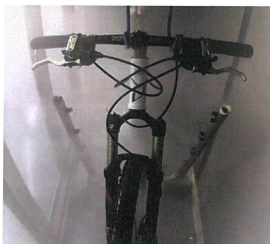
รูปที่ 1.4 แสดงกลไกการทำงานของหัวฉีด ของเครื่องล้างจักรยาน Q BIKE
