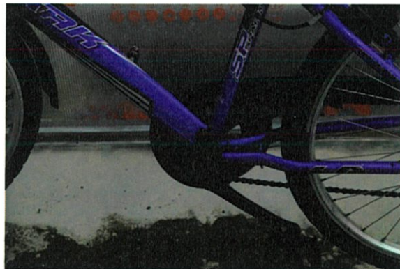
รูปที่ 5.11 ผลการล้างโคลนด้วยการฉีดแบบฟอยปานกลาง
