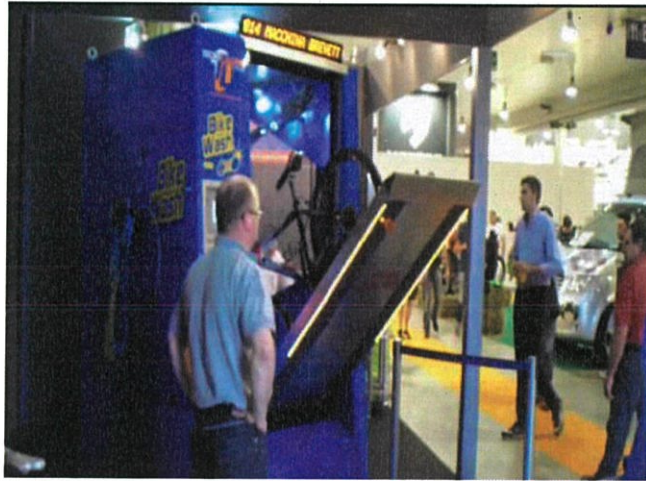
รูปที่ 1.1 แสดงเครื่องล้างจักรยานที่ใช้การยึดล้อแล้วยกจักรยานเข้าเครื่องแบบอัตโนมัติ
