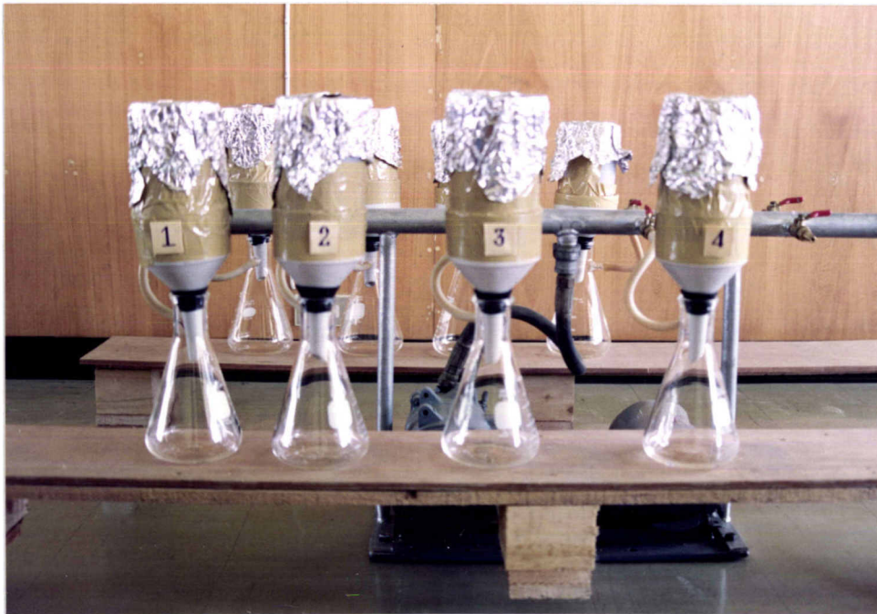
ภาพที่ 5 แสดงการ suction สารละลายดินโดยใช้ vaccum pump
