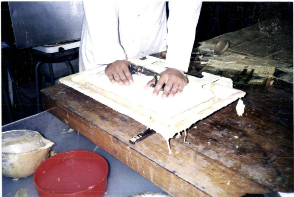
ภาพที่ 6 ขั้นตอนที่ 4 จับฝาปิดด้านบนกดลงกับแม่พิมพ์ด้านล่างสักครู่หนึ่ง
