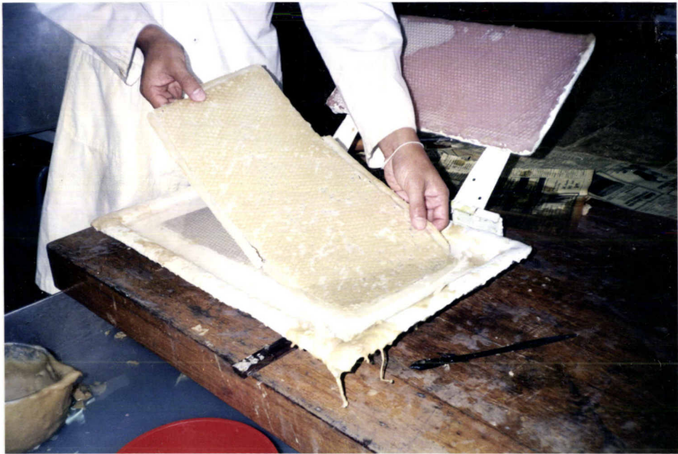
ภาพที่ 9 ขั้นตอนที่ 7 ภาพแผ่นรังเทียมที่ยกแม่พิมพ์ด้านบนออกแล้ว
