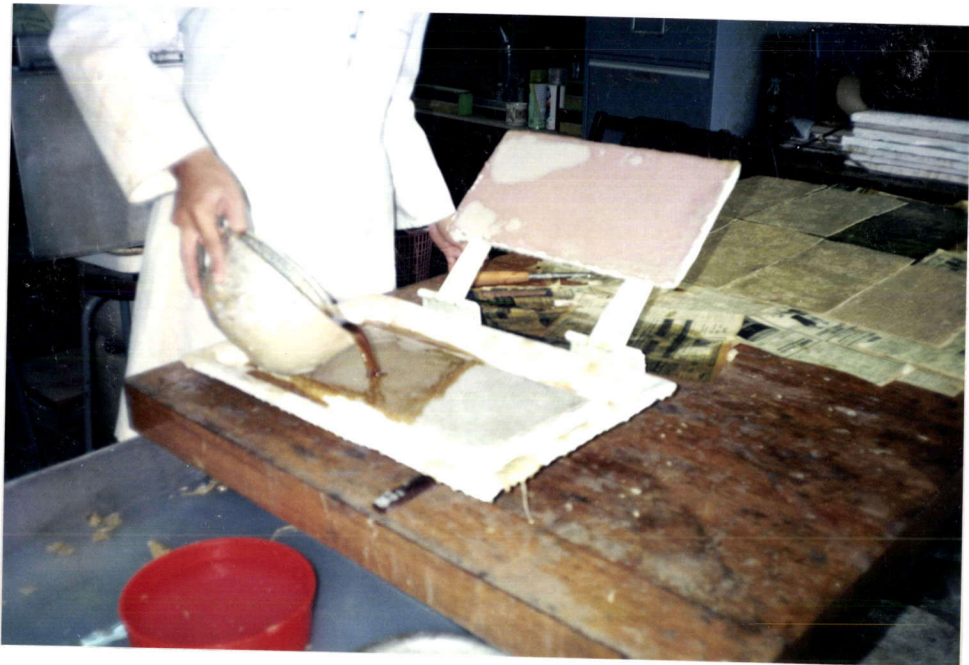
ภาพที่ 5 ขั้นตอนที่ 3 ทาการทေးฟุ้งลงบนแม่พิมพ์ด้านล่าง
