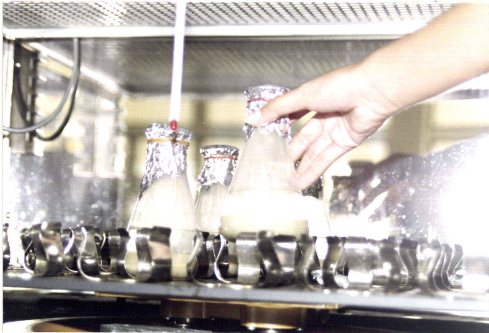
รูปที่ 7 การนำยีสต์ไปทำอโตไลซิสโดยใช้ incubator shaker
