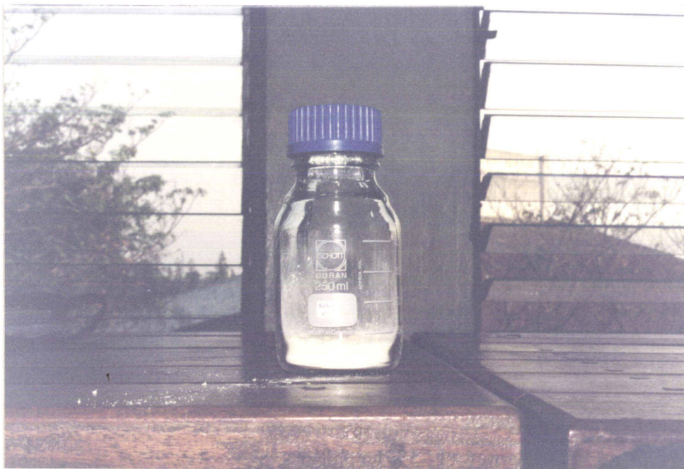
รูปที่ 16 แสดงยีสต์สกัดที่ผ่านการทำให้แห้งโดยใช้เครื่อง spray dryer
