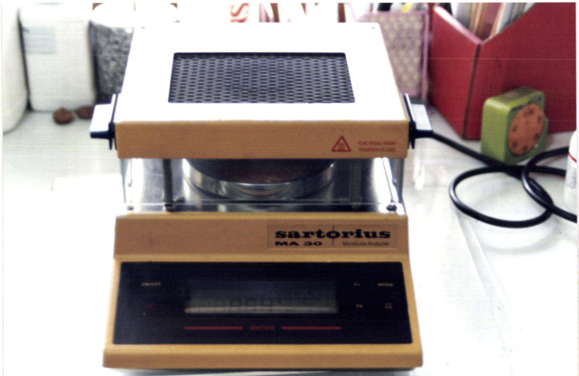
รูปที่ 18 เครื่องวัดปริมาณของแข็ง ( Solid content)
