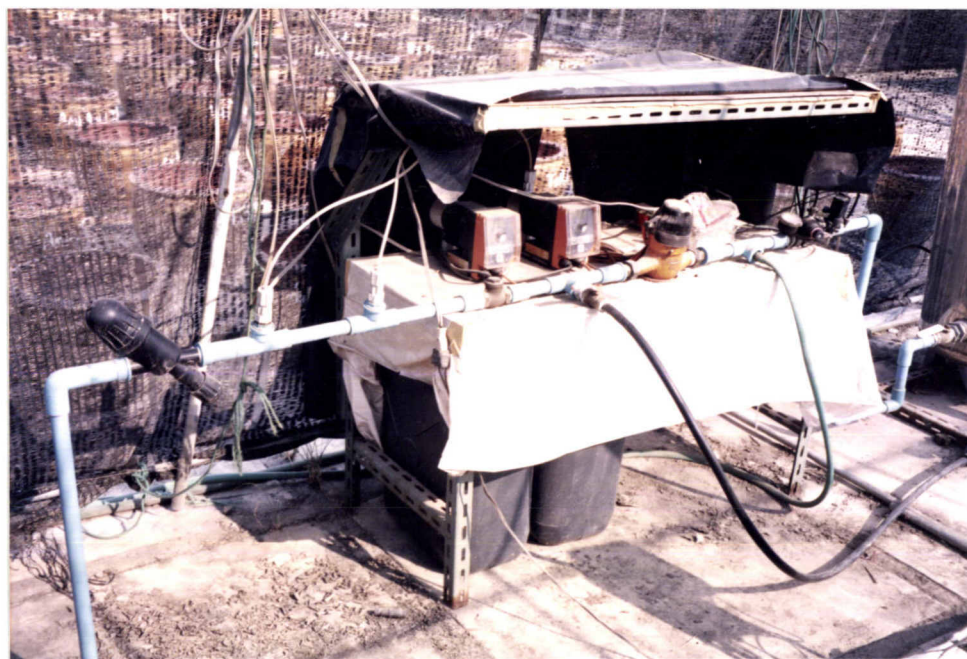
ภาพที่ 9 แสดงระบบการเตรียมสารละลายอัตโนมัติ (1)
