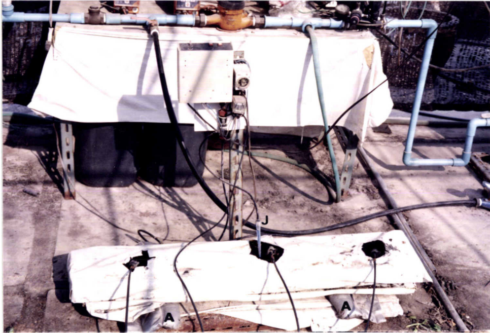
ภาพที่ 11 แสดงเครื่องให้น้ำอัตโนมัติแบบชั่งน้ำหนัก (1)
