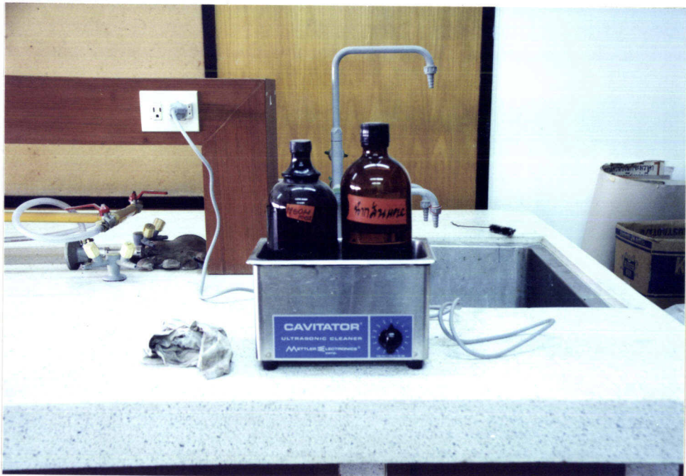
รูปที่ 15 แสดงวิธีการกำจัดฟองอากาศในน้ำกลั่นและเมทานอลที่ใช้กับเครื่อง HPLC โดยใช้ sonicator
