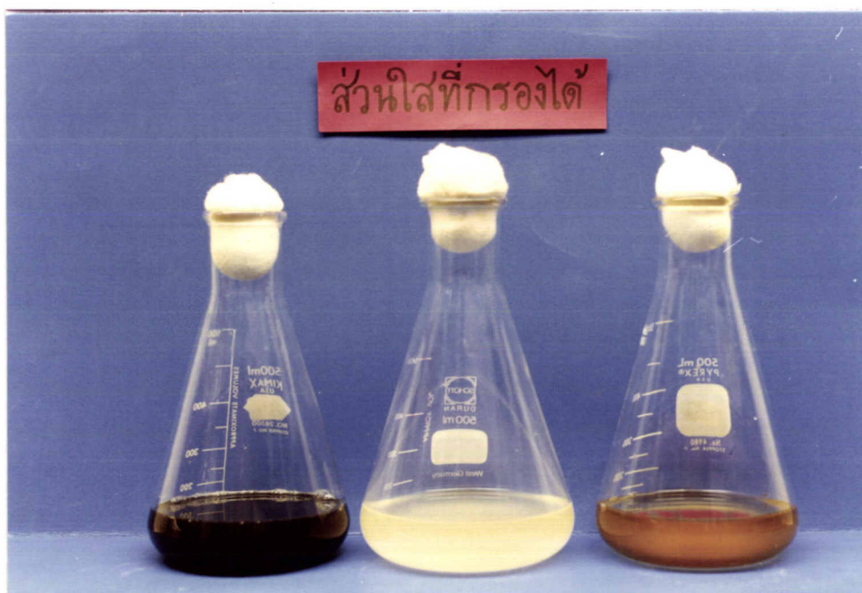
รูปที่ 11 แสดงส่วนใสที่ได้จากการกรองเอาตะกอนออก
