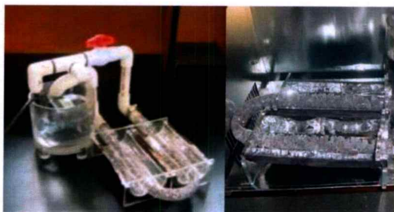
ภาพที่ 2.35 ระบบเครื่องปฏิกรณ์ปฏิกิริยาการกระตุ้นด้วยแสงแบบซีพีซีขนาดย่อม
