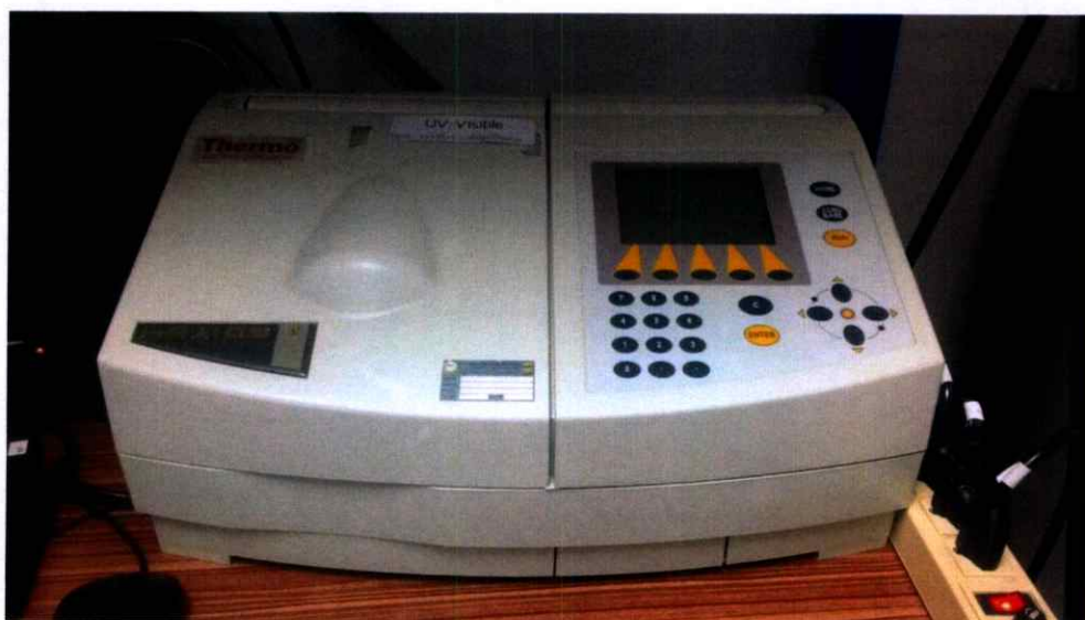
ภาพที่ 3.10 เครื่องยูวี-วิส สเปกโตรโฟโตมิเตอร์ (UV-VIS spectrophotometer)
