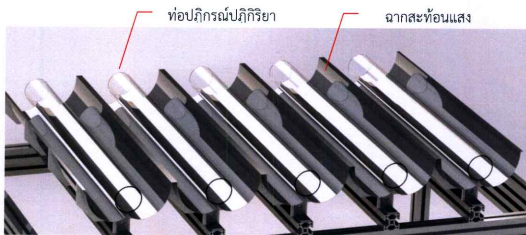
ภาพที่ 3.15 ภาพส่วนของหลอดปฏิกรณ์ปฏิกิริยาและฉากสะท้อนแสงแบบซีพีซี
