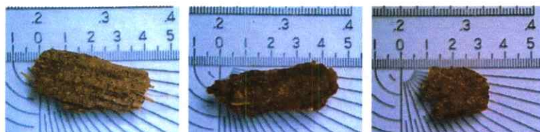
รูปที่ ข-4.2 ขนาดเส้นใยมะพร้าว ที่ค้างอยู่บนตะแกรง Mesh เบอร์ 20
