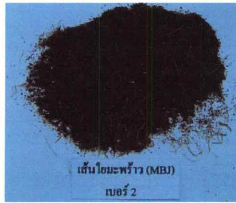
รูปที่ ข-2 ภาพถ่ายแสดงขนาดและความยาวของเส้นใยมะพร้าวขนาด 50 - 80 mesh (เบอร์ 2)
