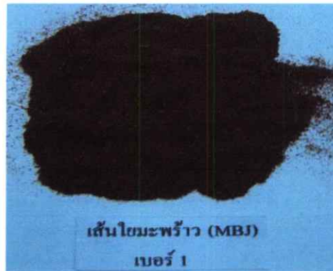
รูปที่ ข-1 ภาพถ่ายแสดงขนาดและความยาวของเส้นใยมะพร้าวขนาด >80 mesh (เบอร์ 1)
