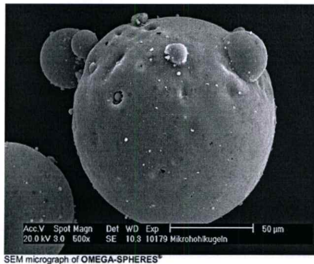
รูปที่ 2.21 ขนาดและลักษณะของเม็ดแก้วกลวง ที่มีขนาดอนุภาค 100 \mu\text{m} [19]
