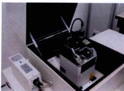
ภาพที่ 3.7 กล้องจุลทรรศน์แรงอะตอม รุ่น Spi - spa400
