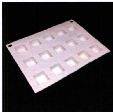
รูปที่ 3.1 แม่พิมพ์ยางซิลิโคน (ก) รูปทรงกระบอก และ (ข) รูปลูกบาศก์
