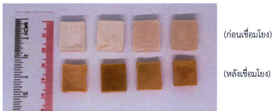
รูปที่ 4.8 ตัวอย่างไฮโดรเจลก่อน และหลังผ่านการเชื่อมโยงด้วยสารละลายกลูตารัลดีไฮด์ 1 เปอร์เซ็นต์โดยปริมาตร ที่อุณหภูมิห้อง
