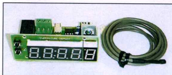
รูปที่ 3.13 โมดูลควบคุมอุณหภูมิ (Temperature controller)
