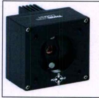
รูปที่ 3.4 ระบบความร้อนควบคุมความยาวคลื่นของเลเซอร์ไดโอด
