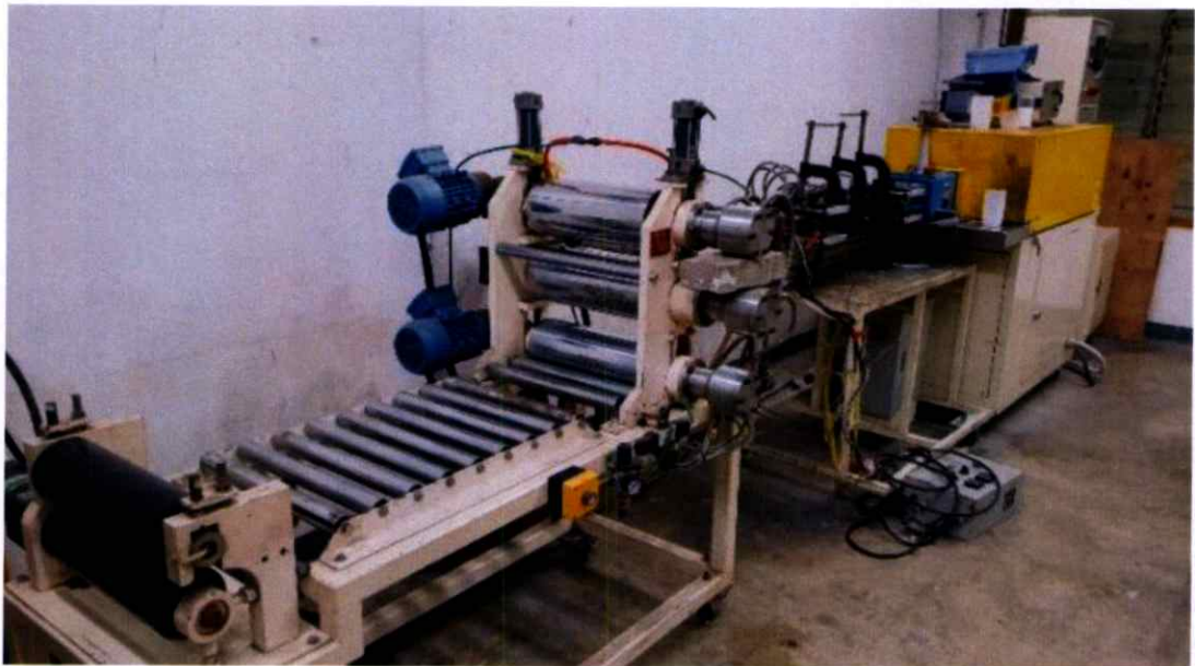
รูปที่ 3.7 เครื่อง Twin screw extruder ต่อด้วยชุดขึ้นรูปฟิล์ม cast film machine
