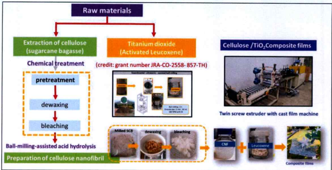
รูปที่ 3.1 แผนภาพแสดงขั้นตอนการเตรียมเส้นใยเซลลูโลสและการขึ้นรูปฟิล์มของวัสดุนาโนคอม- โพสิตของเซลลูโลสและแร่ธรรมชาติ
