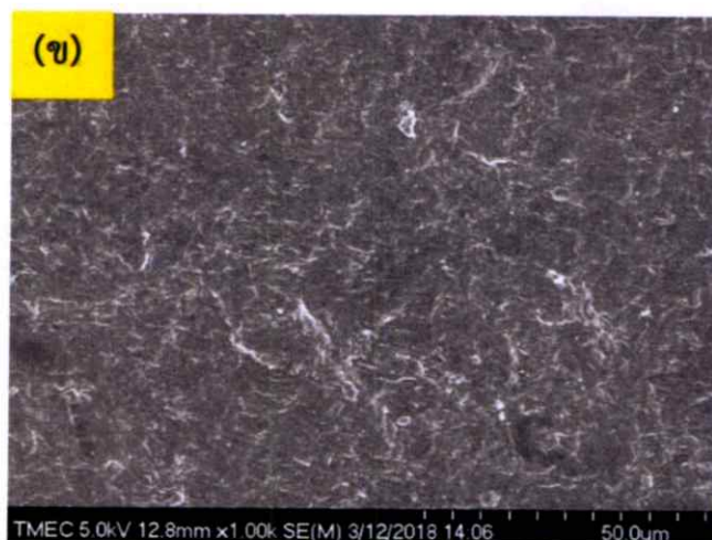
รูปที่ 4.3 ภาพถ่ายลักษณะสัณฐานวิทยาด้วย SEM ของ (ก) ชานอ้อยบดก่อนการปรับสภาพ (ข) ชานอ้อยหลังผ่านการปรับสภาพด้วยกระบวนการทางเคมี
