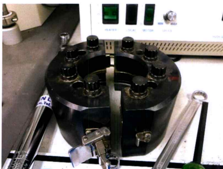
รูปที่ 3.11 อุปกรณ์สำหรับยึดถังปฏิกรณ์ประกอบเข้าเครื่อง Parr reactor
