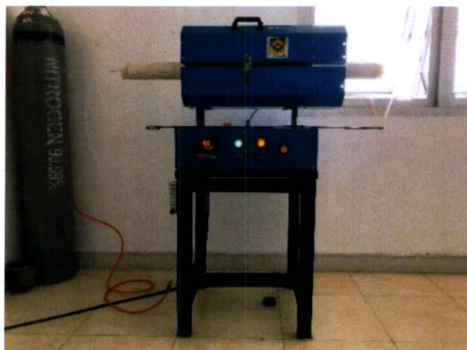
รูปที่ 3.8 เตาปฏิกรณ์สำหรับการคาร์บอนเซชันและแคลไซน์ภายใต้บรรยากาศไนโตรเจนความบริสุทธิ์ 99.99%
