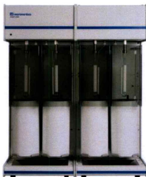
รูปที่ 3.20 เครื่องสำหรับทดสอบการดูดซับด้วยไนโตรเจน
