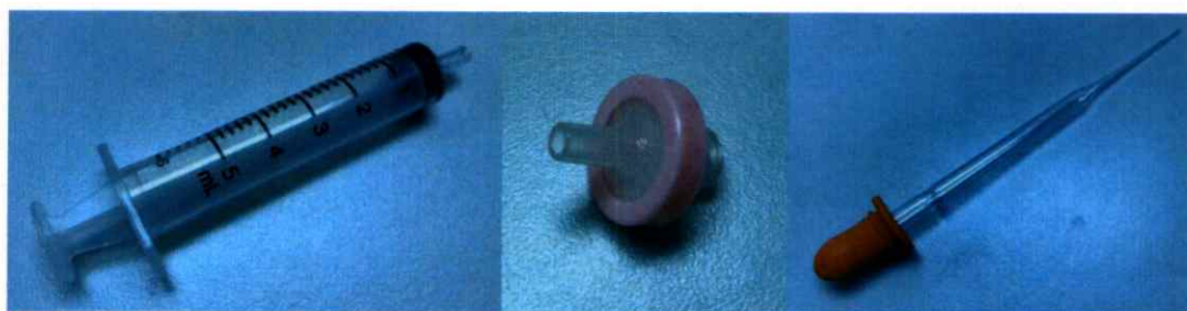
รูปที่ 3.13 หลอดฉีดยา ที่กรองอเนกประสงค์และปิเปตตามลำดับ
