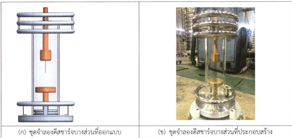
ภาพที่ 3.13 แบบชุดจำลองดีสชาร์จบางส่วนที่ออกแบบและประกอบสร้าง
