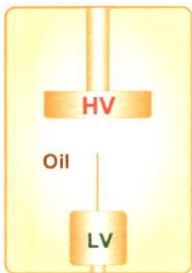
4) โครนาดีสชาร์จด้านแรงดันต่ำในน้ำมันหม้อแปลง
